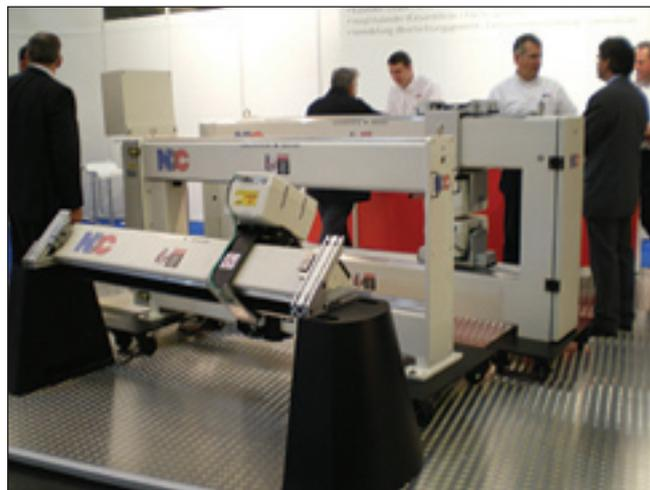
Рис. 8. Узел непрерывного ИК-контроля толщины плоской или сложенной рукавной пленки, представленный на выставке «К-2007» (Дюссельдорф) на стенде компании NDC
