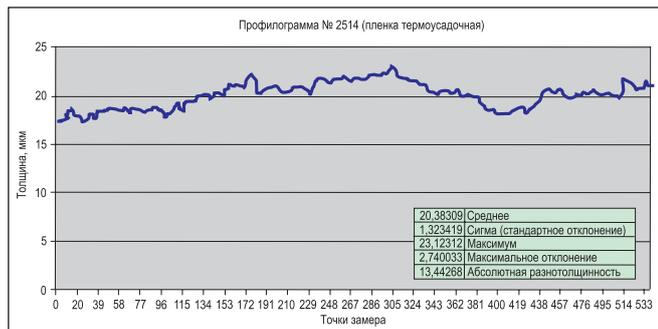
Рис. 7. Профилограмма, построенная с помощью ИК-датчика по 538 точкам на окружности термоусадочной рукавной пленки из ПЭНП
