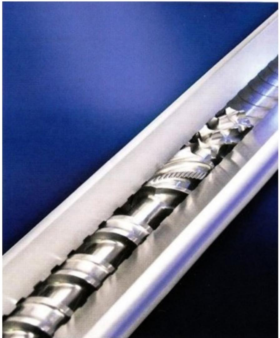
*Рис. 2: Цилиндры с канавками и барьерные шнеки являются неотъемлемыми составляющими технологии Helibar*
